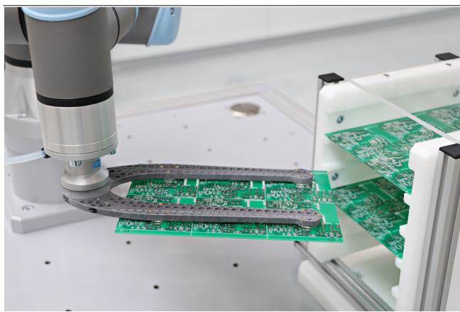
Ventosa flotante SBS Thin para la manipulación de placas de circuitos impresos
